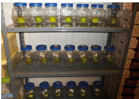
Foto 21. Manzanas en botes herméticos para la medición de la respiración.
